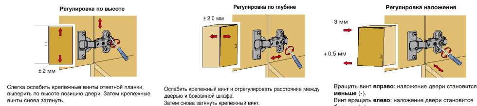
Рис.3 Схема установки петель
